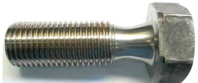
Foto 3: Perno sin uso, fabricado con buen acabado y obedeciendo a buenas prácticas de diseño.
