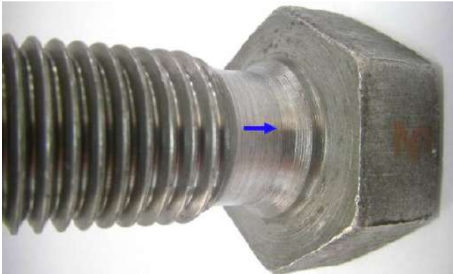
Foto 4: Perno nuevo, con problemas de acabado como ausencia de radio de concordancia y marcas de entrada de Herramienta.
