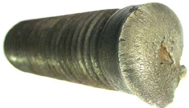
Foto 2: Superficie típica de fractura por fatiga, que corresponde a la gran mayoría de las fracturas de pernos de brida.
