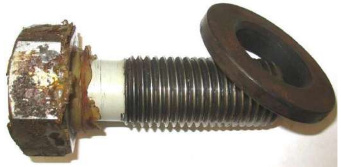
Foto 7: Perno protegido con pintura epoxi y con sello de silicona, después del uso en 3 cosechas, en perfecto estado de conservación.
