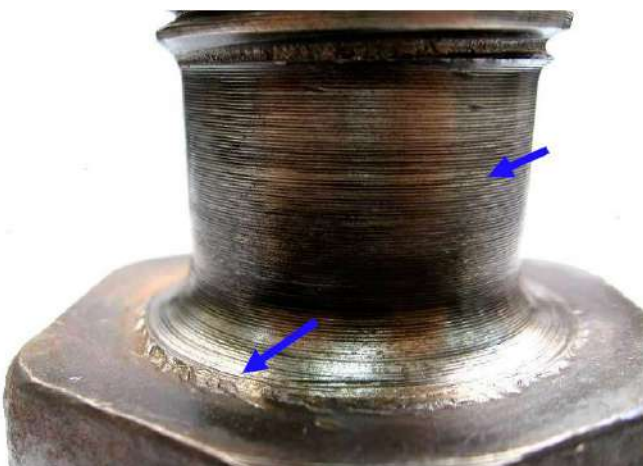
Foto 6: detalle de región donde se perciben fallas de mecanizado y rajaduras profundas que pueden provocar grietas de fatiga.
