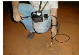
Para verificar las fugas y, en consecuencia, la presencia de alcohol en estado gaseoso retenido debajo del fondo, se realizan varios orificios en las chapas para verificar el peligro de explosividad.
