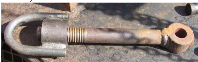
Foto 2 - Aspecto de una abrazadera de fijación fabricada por el usuario en el campo.
