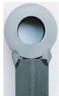
Fotos 3 y 4 - Abrazadera de fijación fabricada en campo antes y después del corte longitudinal, mostrando insuficiencia y subdimensionamiento de la soldadura de unión.
