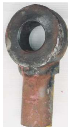
Fotos 3 y 4 - Abrazadera de fijación fabricada en campo antes y después del corte longitudinal, mostrando insuficiencia y subdimensionamiento de la soldadura de unión.
