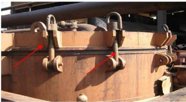
Foto 1 - vista parcial de un calentador que muestra el ensamblado de las abrazaderas de fijación en la tapa.
