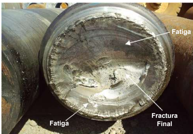
Foto 2 - El aspecto de la superficie de fractura de prácticamente todos los ejes averiados indica la propagación de grietas por fatiga y el sobredimensionamiento del eje, es decir, el área tomada por la propagación de grietas es mucho mayor que la de la fractura final catastrófica.
