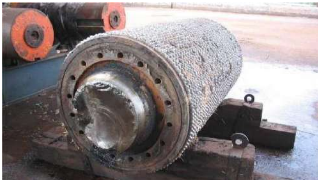
Foto 1 - Eje de molienda fracturado por fatiga durante la cosecha.
