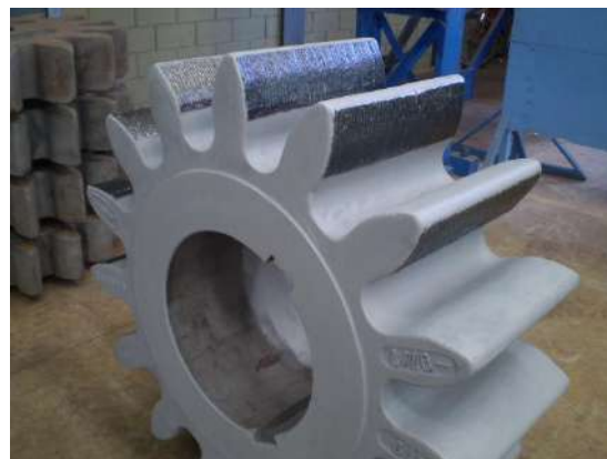
Foto 4 – Rodete reconicionado e pronto para entrar em operação novamente.
