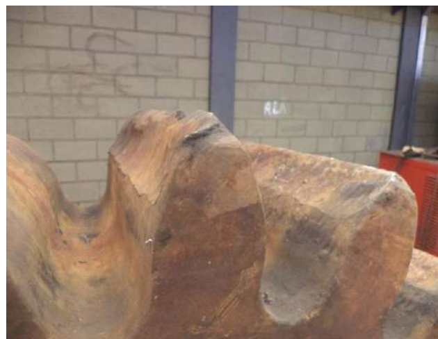
Foto 1 – Aspecto dos dentes desgastados de um rodetete que operou engrenado nas extremidades (acima do diâmetro primitivo) e sofreu desgaste precoce.
