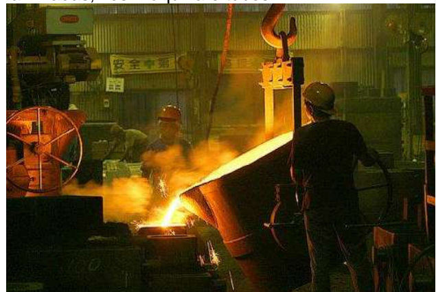
Foto 3: Vazamento de aço fundido para fabricação de produtos semi-acabados.
