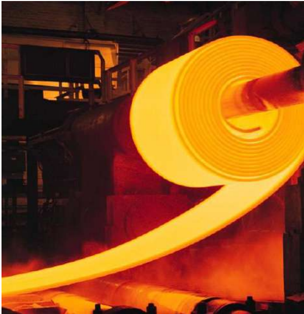
Foto 2: Fabricação de chapas laminadas a quente, em bobinas. A maior quantidade produzida é em aço-carbono série SAE 10XX
