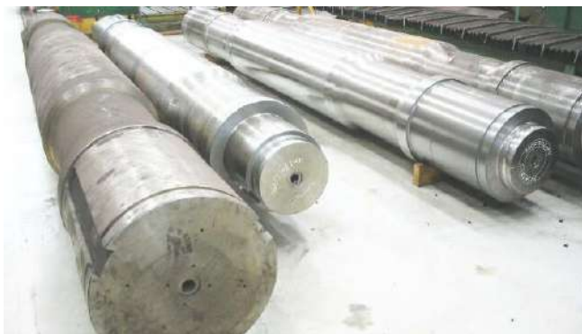
Foto 1: Barras forjadas de aço-carbono SAE 1045 (série 10XX) usadas na fabricação de eixos de moenda.
