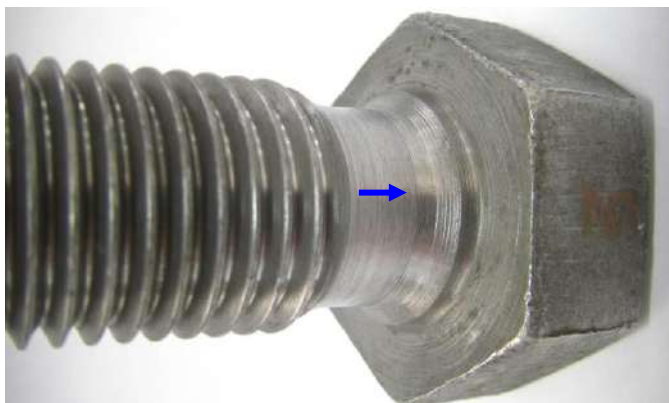
Foto 4: Parafuso novo, com problemas de acabamento como ausência de raio de concordância e marcas de entrada de ferramenta.
