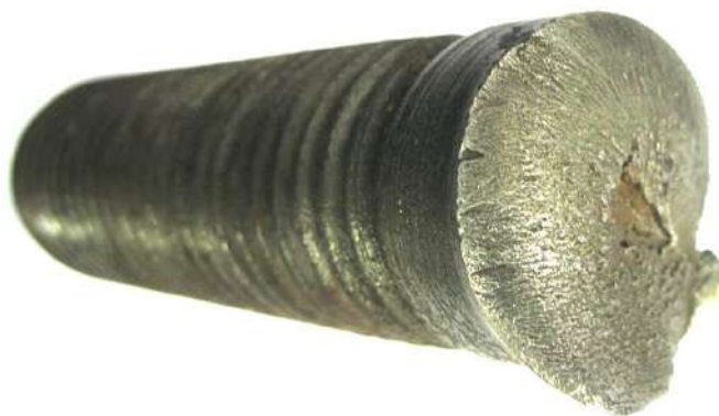
Foto 2: Superfície típica de fratura de fadiga, que corresponde à grande maioria das fraturas de parafusos de flange.
