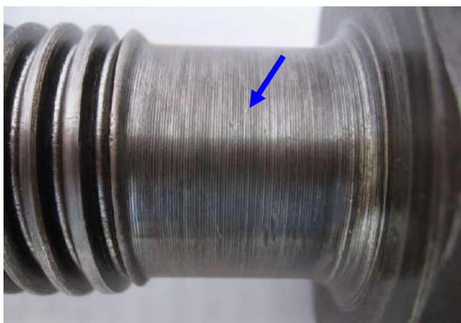
Foto 5: Detalhe do mau acabamento de usinagem de um parafuso novo, em região crítica que deveria estar retificada.
