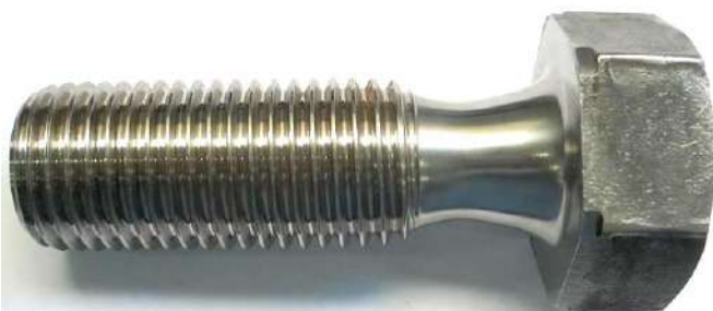
Foto 3: Parafuso sem uso, fabricado com bom acabamento e obedecendo a boas práticas de projeto.
