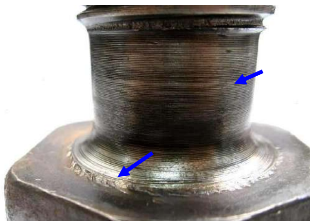
Foto 6: Detalhe de região onde se percebem trepidações de usinagem e riscos profundos que podem provocar trincas de fadiga.
