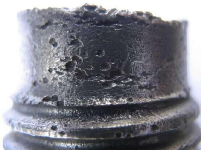
Foto 1: Parafuso fraturado devido à nucleação de trincas em sítios de corrosão provocados por problemas de vedação.
