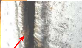
Ruptura da solda do costado causando vazamento de melão em um tanque que foi projetado para receber álcool. No detalhe, a solda que apresentou defeito grave de falta de penetração.
