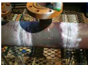
Utilização de conexão Tee de material incorreto (diferente do especificado), que veio a provocar trinca durante a operação de uma linha de vapor de alta pressão.
