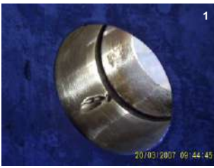
1 – Sulco provocado pela falta de habilidade na remoção de um tubo mandrilhado de um balão de caldeira.
