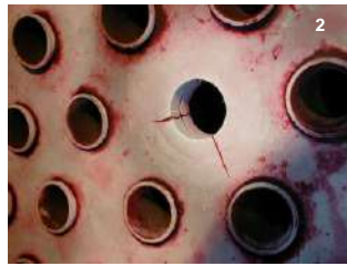
1 – Sulco provocado pela falta de habilidade na remoção de um tubo mandrilhado de um balão de caldeira.
