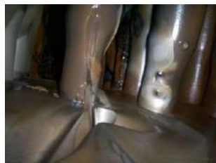
Cavidades provocadas por abrasão em balão de caldeira de alta pressão e temperatura, devido a vazamento de vapor entre o tubo e o balão, na região mandrilhada.
