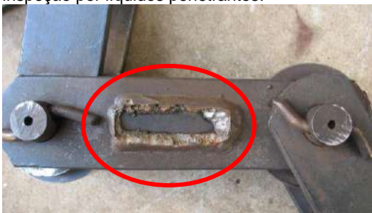
Lateral com rompimento do aditamento devido à má qualidade da solda de fixação.
