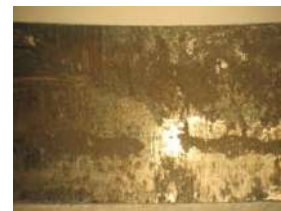
Fratura/trinca ocorridas em laterais devido ao excesso de aperto de montagem, provocado por conicidade e mau acabamento do furo. As fotos inferiores mostram detalhes do acabamento ruim na superfície dos furos das laterais.
