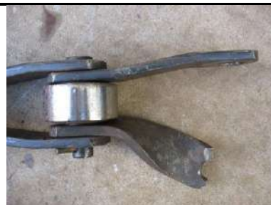
Elo de corrente com fratura da lateral na região do furo.
