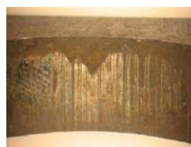
Fratura/trinca ocorridas em laterais devido ao excesso de aperto de montagem, provocado por conicidade e mau acabamento do furo. As fotos inferiores mostram detalhes do acabamento ruim na superfície dos furos das laterais.
