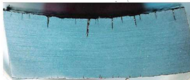
Trincas nucleadas nas superfícies interna e externa de uma Conexão T, devido a fadiga, causada por falta de flexibilidade na linha de vapor (vista ampliada da parede da conexão em corte transversal).
