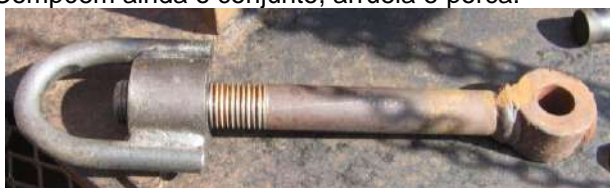
Foto 2 – Aspecto de um grampo de fixação fabricado pelo usuário em campo.
