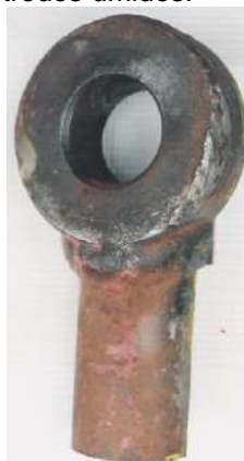
Fotos 3 e 4 – Grampo de fixação fabricado em campo antes e após secionamento longitudinal, mostrando insuficiência e subdimensionamento da solda de união.
