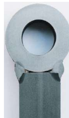
Fotos 3 e 4 – Grampo de fixação fabricado em campo antes e após secionamento longitudinal, mostrando insuficiência e subdimensionamento da solda de união.
