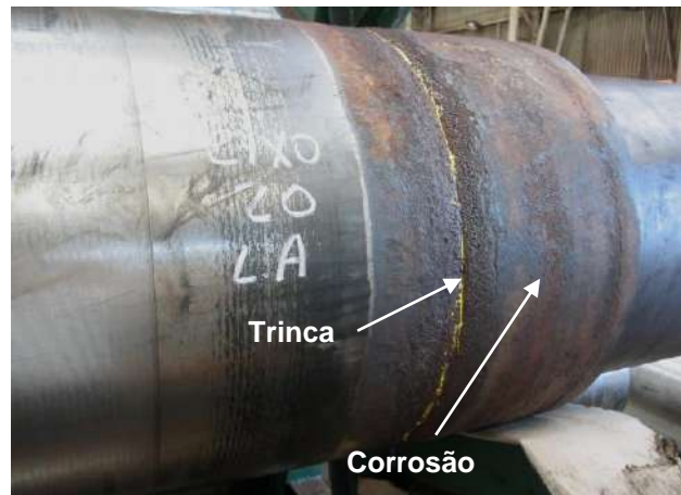
Foto 3 - Eixo sem a camisa, com corrosão intensa e nucleação de trinca na região de vedação.
