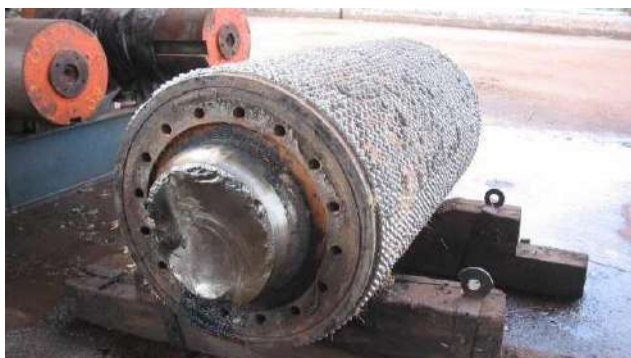
Foto 1 - Eixo de moenda fraturado por fadiga durante a safra.
