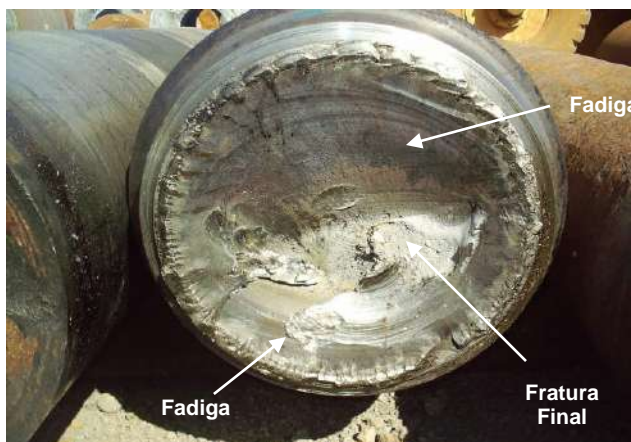
Foto 2 - O aspecto da superfície de fratura de praticamente todos os eixos fraturados indica propagação de trincas por fadiga e superdimensionamento do eixo, ou seja, a área tomada pela propagação das trincas é muito maior que a da fratura final catastrófica.
