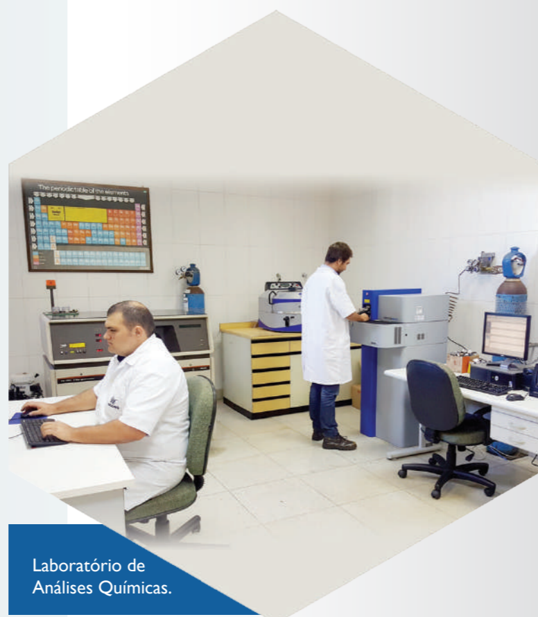
Espectrômetro de emissão óptica para análises químicas de metais ferrosos e não-ferrosos e ligas metálicas diversas.
