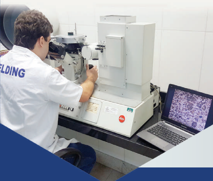
Banco metalográfico Leitz para pesquisa e desenvolvimento, além de análises metalográficas e de microdureza rotineiras. Utilização de software de análise de imagem, possibilitando maior precisão para medição de tamanho de grãos, percentual de fases, classificação de nódulos de grafita, entre outros.
