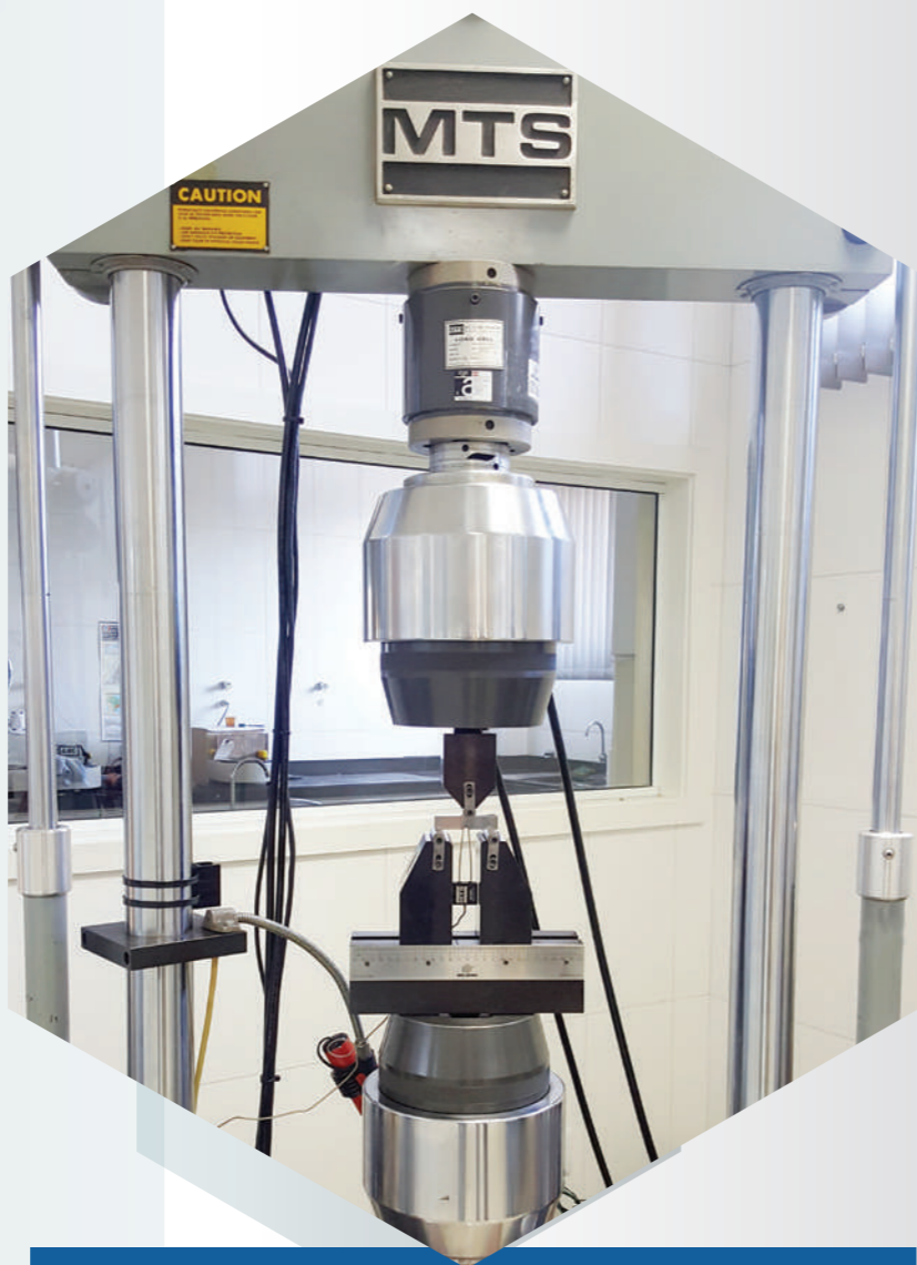
Máquina de ensaios dinâmicos com acionamento servo-hidráulico de circuito fechado (MTS 810 – 250 kN), para ensaios cíclicos de fadiga de alto e baixo ciclo ( \sigma -N e \epsilon -N) e ensaios de tenacidade à fratura para a determinação das propriedades de K_{IC} , CTOD e Integral J
