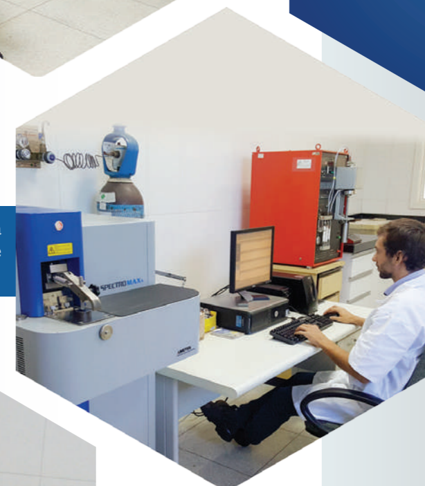
Forno de indução para fusão de produtos fragmentados (telas, arames) e microcomponentes, em atmosfera controlada com argônio, para possibilitar uma superfície mínima de queima e precisão nas análises químicas.
