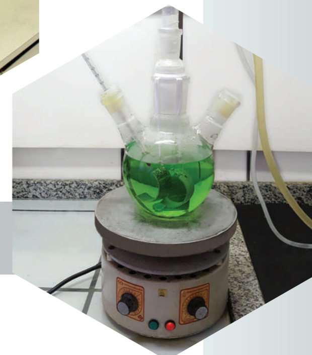
Ensaio Decay Test para avaliação da solubilização de soldas na fabricação de tubos inox com costura e outras soldas.
