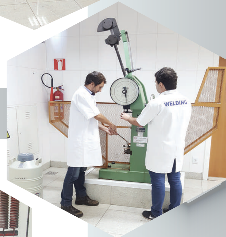
Máquina Universal Wolpert, capacidade de 300 Joules, para ensaios de impacto em temperaturas diversas (baixa, ambiente, alta).
