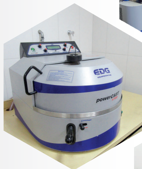
Forno de indução para fusão de produtos fragmentados (telas, arames) e microcomponentes, em atmosfera controlada com argônio, para possibilitar uma superfície mínima de queima e precisão nas análises químicas.
