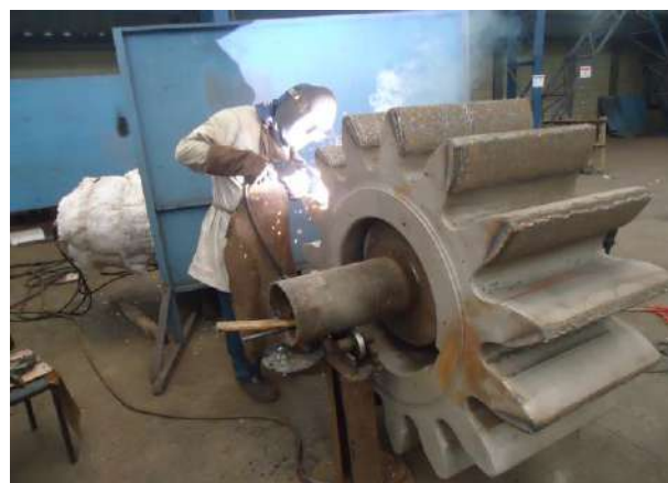
Foto 3 - Piñones durante la aplicación final de la soldadura fuerte de revestimiento.
