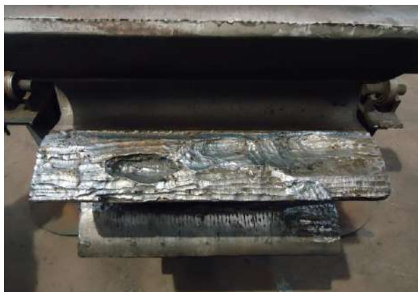
Foto 2 - Dientes en proceso de grafitó y preparación para la soldadura.
