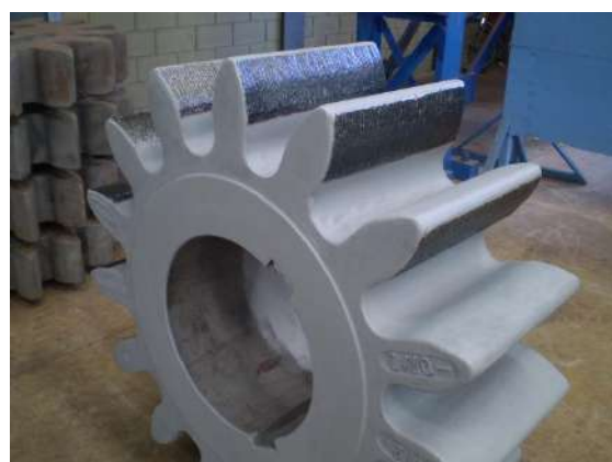
Foto 4 - Piñón reacondicionado y listo para volver a operar.
