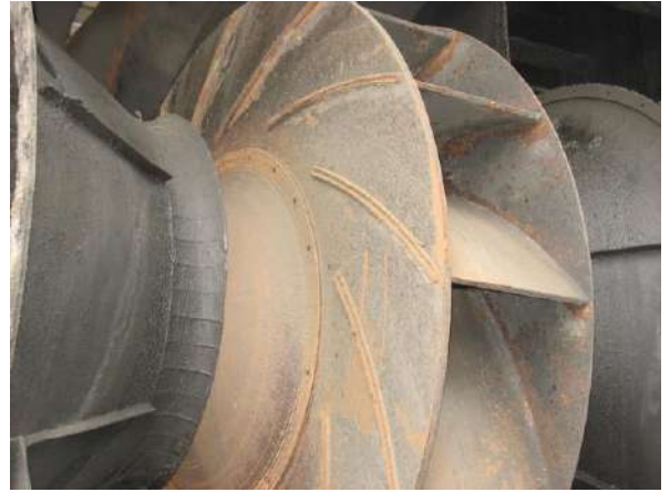
Foto 4– Aspecto del rotor después del desprendimiento de las aletas.
