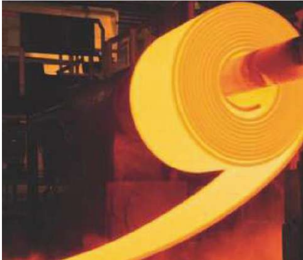
Foto 2: fabricación de chapas laminadas en caliente, en bobinas. La mayor cantidad producida es de acero al carbono serie SAE 10xx
