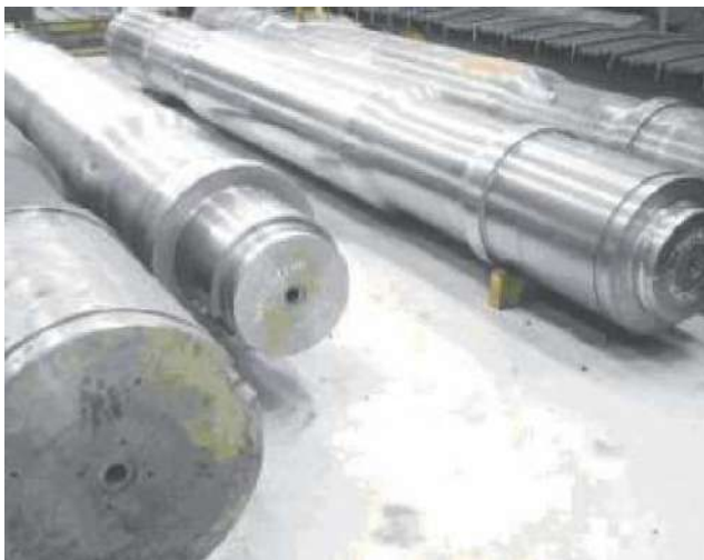
Foto 1: Barras forjadas de acero al carbono SAE 1045 (serie 10xx) utilizadas en la fabricación de ejes de molineta.
