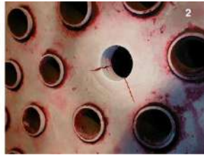
1 - Surco provocado por la falta de habilidad en la extracción de un tubo mandril de un matraz de caldera.
