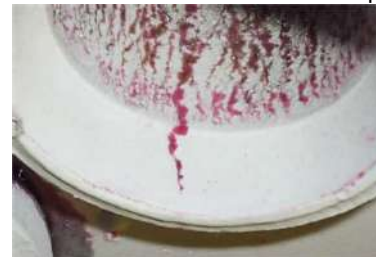
Gran cantidad de grietas ocurridas durante el mandrilado, ocasionadas por la falta de tratamiento térmico en la punta del tubo con reducción.
