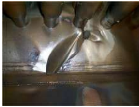
Cavidades provocadas por abrasión en matraz de caldera de alta presión y temperatura, debido a fuga de vapor entre el tubo y el matraz, en la región mandrilada.
