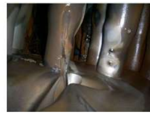
Cavidades provocadas por abrasión en matraz de caldera de alta presión y temperatura, debido a fuga de vapor entre el tubo y el matraz, en la región mandrilada.
