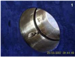
1 - Surco provocado por la falta de habilidad en la extracción de un tubo mandril de un matraz de caldera.
