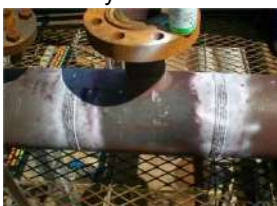
Uso de conexión en T con material incorrecto (distinto del especificado), que provocó agrietamiento durante el funcionamiento de una tubería de vapor de alta presión.
