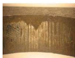
Fractura/grietas ocurridas en laterales debido al exceso de apriete de ensamblado, provocado por conicidad y mal acabado del agujero. Las fotos inferiores muestran detalles del mal acabado en la superficie de los hoyos laterales.
