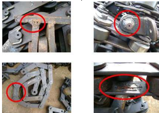
Algunos defectos encontrados en cadenas armadas: soldaduras mal ejecutadas, aprovechamiento indebido de componentes.
