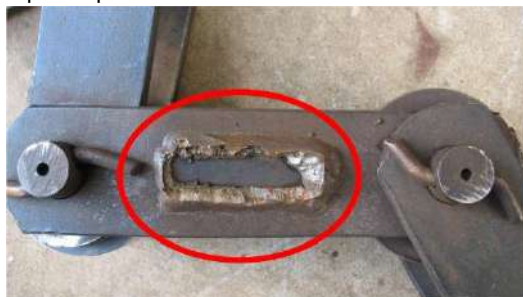
Lateral con rotura del aditivo debido a la mala calidad de la soldadura de fijación.
