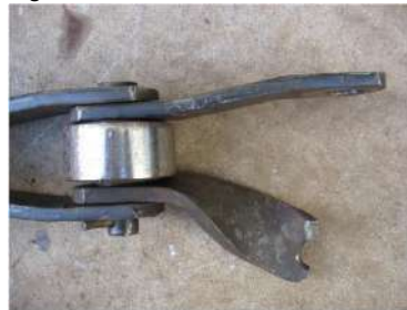
Eslabón de cadena con fractura lateral en la región del agujero.
