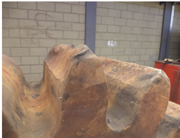
Foto 1 – Aspecto dos dentes desgastados de um rodete que operou engrenado nas extremidades (acima do diâmetro primitivo) e sofreu desgaste precoce.
