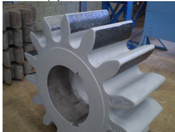
Foto 4 – Rodete recondicionado e pronto para entrar em operação novamente.
