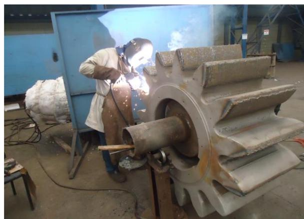
Foto 3 - Piñones durante la aplicación final de la soldadura fuerte de revestimiento.
