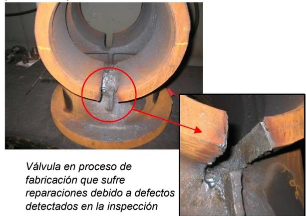
*Válvula en proceso de fabricación que sufre reparaciones debido a defectos detectados en la inspección*
