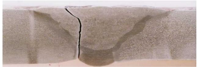
*Grieta iniciada en la raíz de la soldadura de fijación de una curva, debido a un defecto de soldadura causado por la falta de habilidad del soldador.*
