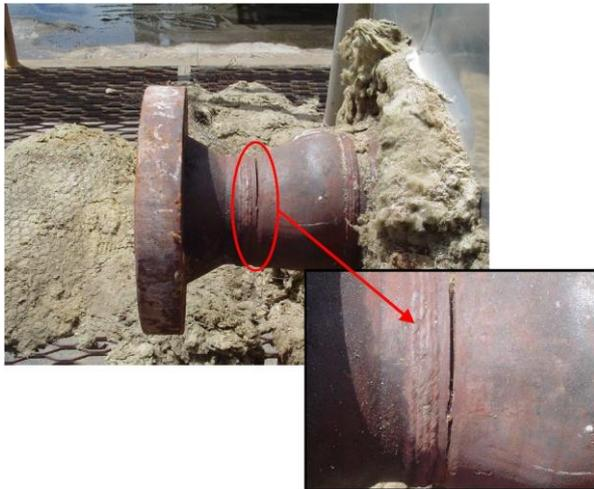
*Ruptura de una reducción excéntrica de tubería de vapor de alta presión y alta temperatura, debido al uso de componente que no correspondía a la identificación estampada en su cuerpo (clasificado como ASTM A234 WP11 y era acero al carbono).*
