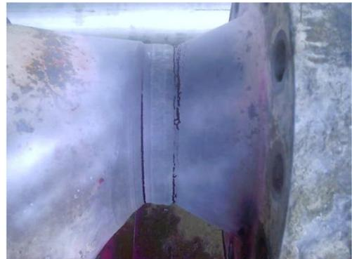
*Grietas causadas por el uso de procedimiento de soldadura inadecuado.*
